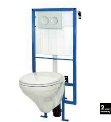
LIVE UP 115 x 51,5 cm Pack WC Suspendu - WC set complet - Bâti-support composé d'une structure en métal facilement ajustable - à fixer au sol et au mur - CE, NF: EN 14055 - Alimentation d'eau silencieuse - Flotteur de qualité NF - Cuvette en porcelaine - Plaque de commande grise - Double bouton poussoir 3/6L - Abattant en thermoplastique. Wc-pack Hangend - complete set - Frame aanpasbaar voor muur of grondbevestiging - CE, NF: EN 14055 kwaliteitscertificaat - Geruisloze watertoevoer - Kwalitatieve vlotter NF - Wc-pot in porselein - Grijs duwplaat - Dubbele druktoets 3/6L - Wc zitting in thermoplastiek.
