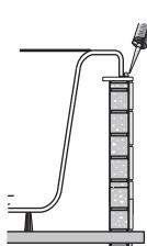
Faire un joint de silicone autour du trou de la bonde de vidage entre la partie Toplax et la bague P.V.C. , et autour de la pièce métallique.
